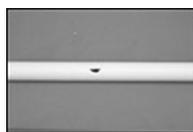
**A)** Para resolver os problemas que ocorrem em pontos localizados nos tubos em instalações já concluídas, em consequência de pequenos acidentes (furos por pregos ou furadeiras), ou vazamentos em juntas mal executadas, a TIGRE oferece aos seus consumidores a Luva de Correr TIGRE;
