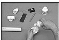
**b)** Limpar as superfícies lixadas com Solução Limpadora TIGRE, eliminando impurezas e gorduras. Observar que o encaixe deve ser bastante justo, quase impraticável sem o adesivo, pois sem pressão não se estabelece a soldagem;
